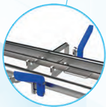
1. Guidage de la bande en ligne
