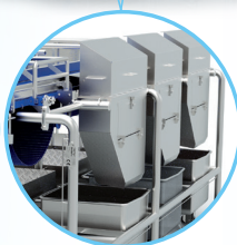
3. Goulottes pour produit conforme ou non conforme
